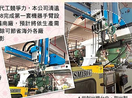
▲從射出機台中，取出製成品的機器手臂
